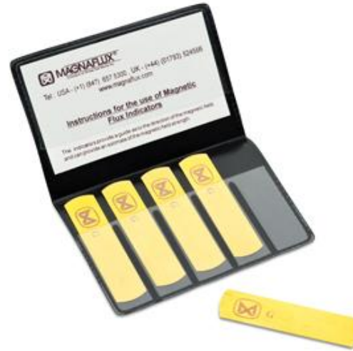
MPI Kalibre çubuğu. 5 lamine Multi Metal.
