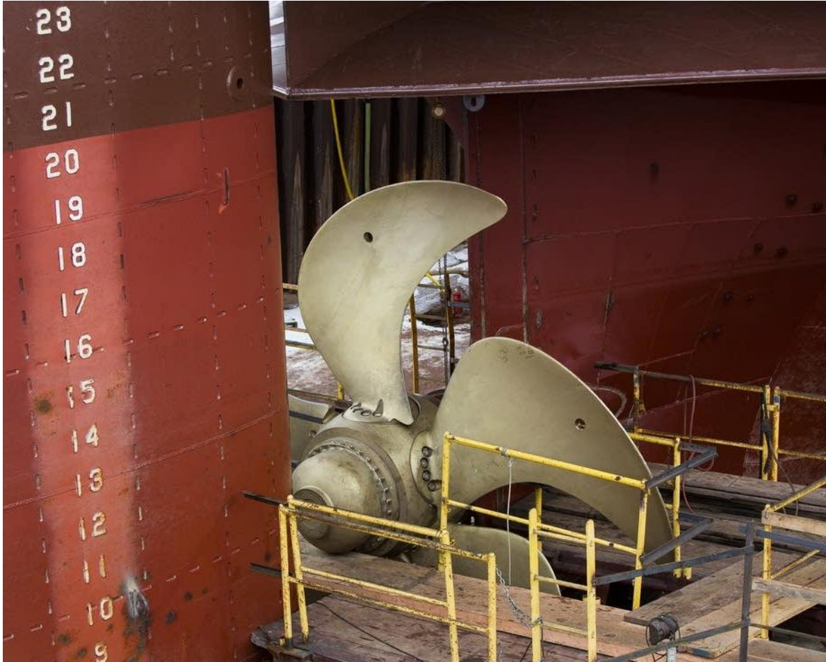
CPP Controlable Pitch Propeller Ayarlanabilir kanatlı pervane
